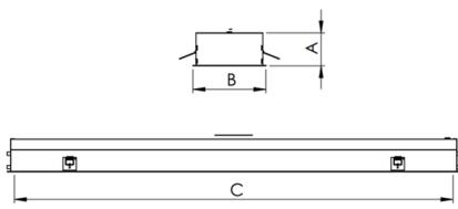
Luminária retangular de embutir em forro modulado, 40W 4000K IRC>80. Corpo em alumínio. Acabamento Branca, Preta ou Especial. Controle óptico principal através de difusor em poliestireno translúcido. Luminária grau de proteção IP-20. Driver corrente constante Liga/Desliga, Triac, 1-10V ou Dali (consultar condições). Tensão de trabalho 220V ou Bivolt.
