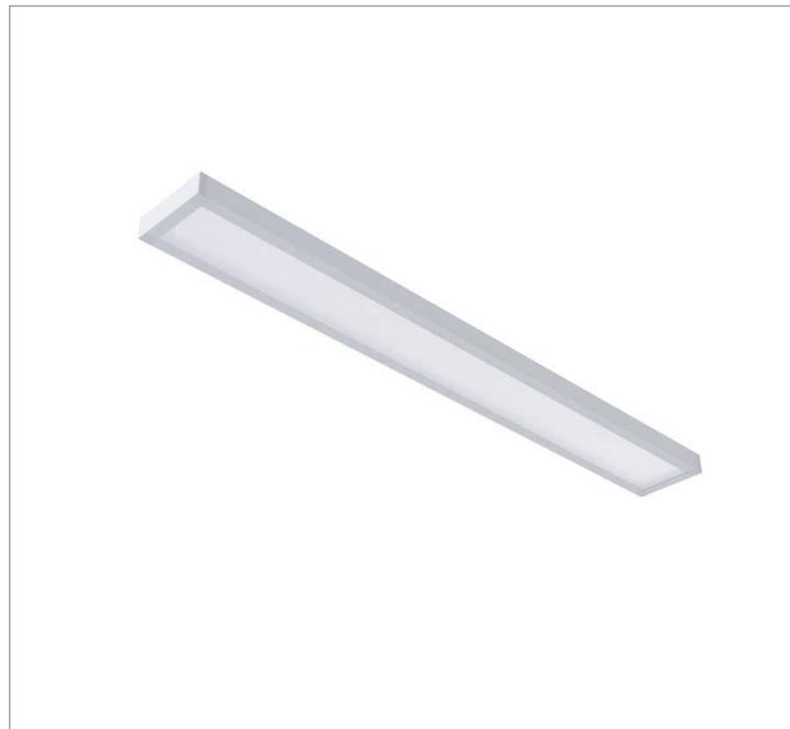
Luminária retangular de sobrepor, 40W 3000K IRC>80. Corpo em alumínio. Acabamento Branca, Preta ou Especial. Controle óptico principal através de difusor em poliestireno translúcido. Luminária grau de proteção IP-20. Driver corrente constante Liga/Desliga, Triac, 1-10V ou Dali (consultar condições). Tensão de trabalho 220V ou Bivolt.
