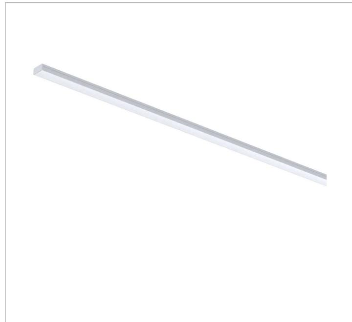
Luminária linear de sobrepor, 15Wm 3000K IRC>80. Corpo em alumínio. Acabamento Branca, Preta ou Especial. Controle óptico principal através de difusor extrudado. Luminária grau de proteção IP-20. Driver corrente constante Liga/Desliga, Triac, 1-10V ou Dali (consultar condições). Tensão de trabalho 220V ou Bivolt.
