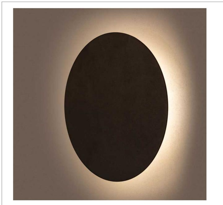
Luminária circular arandela iluminação direta e indireta, 8W 3000K IRC>80. Corpo em alumínio. Acabamento Branca, Preta ou Especial. Controle óptico principal através de facho Difuso Direto e Indireto. Luminária grau de proteção IP-20. Driver corrente constante Liga/Desliga Tensão de trabalho 127V ou 220V.
