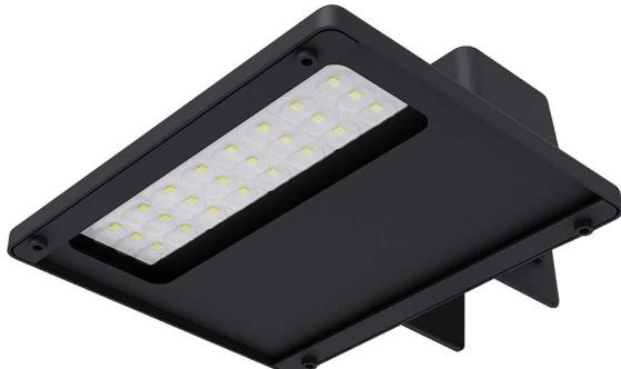
Luminária arandela iluminação direta, 100W 5000K IRC70. Corpo em alumínio. Acabamento preto. Controle óptico principal através de lente facho Street. Luminária grau de proteção IP-65. Driver constante Liga/Desliga, Triac, 1-10V ou Dali (consultar condições). Tensão de trabalho 220V.
