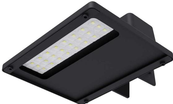
Luminária arandela iluminação direta, 150W 4000K IRC70. Corpo em alumínio. Acabamento preto. Controle óptico principal através de lente facho Street. Luminária grau de proteção IP-65. Driver constante Liga/Desliga, Triac, 1-10V ou Dali (consultar condições). Tensão de trabalho 220V.
