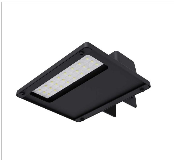
Luminária arandela iluminação direta, 50W 5000K IRC70. Corpo em alumínio. Acabamento preto. Controle óptico principal através de lente fecho Street. Luminária grau de proteção IP-65. Driver corrente constante Liga/Desliga, Triac, 1-10V ou Dali (consultar condições). Tensão de trabalho 220V.
