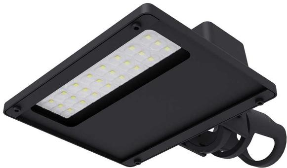
Pétala, 120W 4000K IRC70. Corpo em alumínio. Acabamento preto. Controle óptico principal através de lente facho Street. Luminária grau de proteção IP-65. Driver corrente constante Liga/Desliga, Triac, 1-10V ou Dali (consultar condições). Tensão de trabalho 220V.
