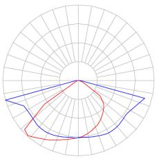
Pétala, 120W 5000K IRC70. Corpo em alumínio. Acabamento preto. Controle óptico principal através de lente facho Street. Luminária grau de proteção IP-65. Driver corrente constante Liga/Desliga, Triac, 1-10V ou Dali (consultar condições). Tensão de trabalho 220V.
