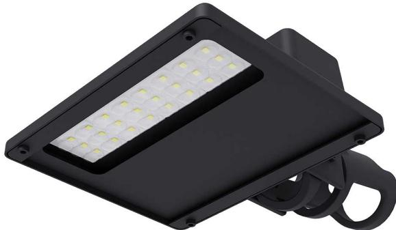
Pétala, 120W 5000K IRC70. Corpo em alumínio. Acabamento preto. Controle óptico principal através de lente facho Street. Luminária grau de proteção IP-65. Driver corrente constante Liga/Desliga, Triac, 1-10V ou Dali (consultar condições). Tensão de trabalho 220V.
