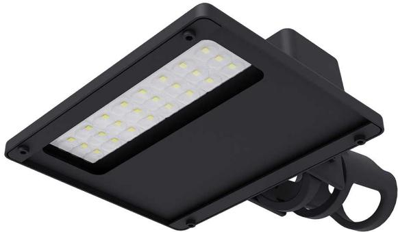
Pétala, 150W 4000K IRC70. Corpo em alumínio. Acabamento preto. Controle óptico principal através de lente facho Street. Luminária grau de proteção IP-65. Driver corrente constante Liga/Desliga, Triac, 1-10V ou Dali (consultar condições). Tensão de trabalho 220V.
