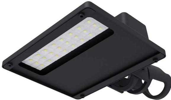
Pétala, 50W 4000K IRC70. Corpo em alumínio. Acabamento preto. Controle óptico principal através de lente facho Street. Luminária grau de proteção IP-65. Driver corrente constante Liga/Desliga, Triac, 1-10V ou Dali (consultar condições). Tensão de trabalho 220V.
