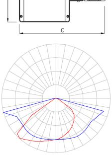
Pétala, 50W 4000K IRC70. Corpo em alumínio. Acabamento preto. Controle óptico principal através de lente facho Street. Luminária grau de proteção IP-65. Driver corrente constante Liga/Desliga, Triac, 1-10V ou Dali (consultar condições). Tensão de trabalho 220V.
