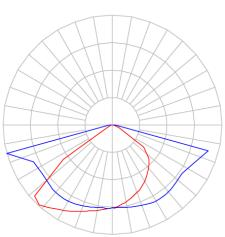
Pétala, 50W 5000K IRC70. Corpo em alumínio. Acabamento preto. Controle óptico principal através de lente facho Street. Luminária grau de proteção IP-65. Driver corrente constante Liga/Desliga, Triac, 1-10V ou Dali (consultar condições). Tensão de trabalho 220V.
