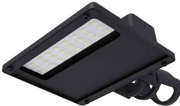
Pétala, 70W 5000K IRC70. Corpo em alumínio. Acabamento preto. Controle óptico principal através de lente facho Street. Luminária grau de proteção IP-65. Driver corrente constante Liga/Desliga, Triac, 1-10V ou Dali (consultar condições). Tensão de trabalho 220V.
