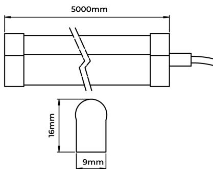
Perfil LED flexível Side Bend (dobra lateral) 7,2W/m máximo RGB. Corpo em silicone co-extrusado branco e translúcido. Luminária grau de proteção IP-65. Tensão de trabalho 24VCC. Necessita adicionar controle de dimerização com 3 canais de saída.
