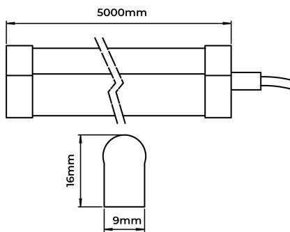
Perfil LED flexível Side Bend (dobra lateral) 9,6Wm máximo 3000K IRC90. Corpo em silicone co-extrusado branco e translúcido. Luminária grau de proteção IP-65. Tensão de trabalho 24VCC.
