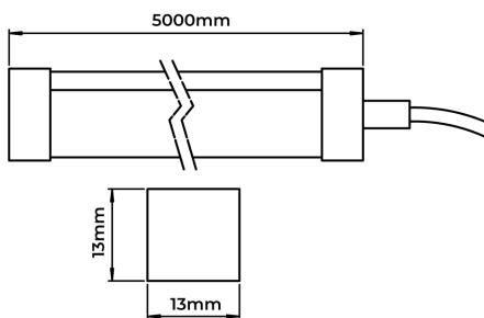
Perfil LED flexível Top bend (dobra frontal) 9,6Wm máximo RGBW. Corpo em silicone co-extrusado branco e translúcido. Luminária grau de proteção IP-65. Tensão de trabalho 24VCC. Necessita adicionar controle de dimerização com 3 canais de saída.
