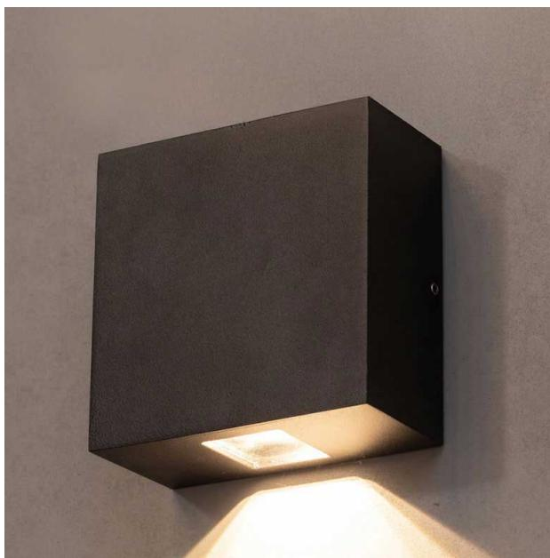
Luminária quadrada arandela iluminação direta, 4W 3000K IRC>80. Corpo em alumínio. Acabamento Branca, Preta ou Especial. Controle óptico principal através de facho Difuso Direto. Luminária grau de proteção IP-20. Driver corrente constante Liga/Desliga Tensão de trabalho 127V ou 220V.
