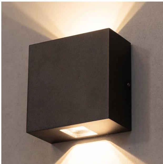
Luminária quadrada arandela iluminação direta e indireta, 8W 3000K IRC>80. Corpo em alumínio. Acabamento Branca, Preta ou Especial. Controle óptico principal através de facho Difuso Direto e Indireto. Luminária grau de proteção IP-20. Driver corrente constante Liga/Desliga Tensão de trabalho 127V ou 220V.
