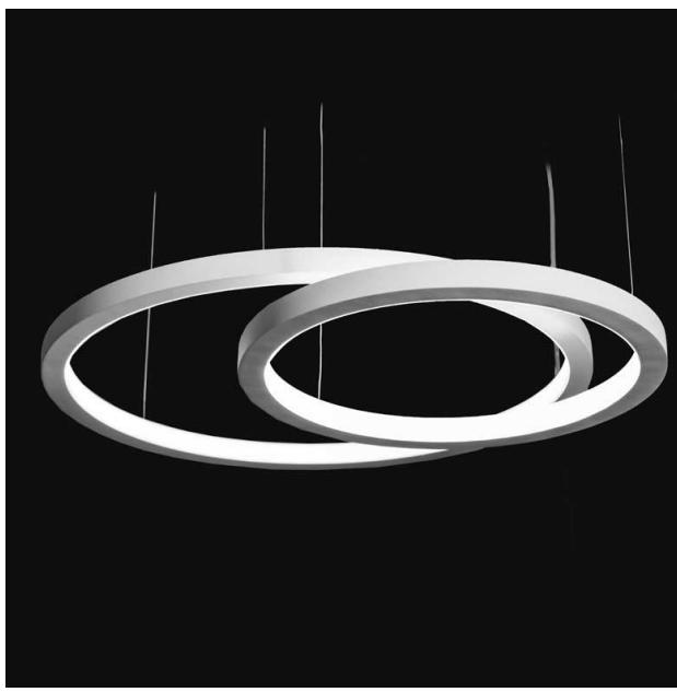
Luminária circular pendente iluminação direta e indireta, 36W 4000K IRC90. Corpo em alumínio. Acabamento branco, preto ou especial. Controle óptico principal através de facho difuso. Luminária grau de proteção IP-20. Driver corrente constante Liga/Desliga, Triac, 1-10V ou Dali (consultar condições). Tensão de trabalho 220V ou Bivolt.
