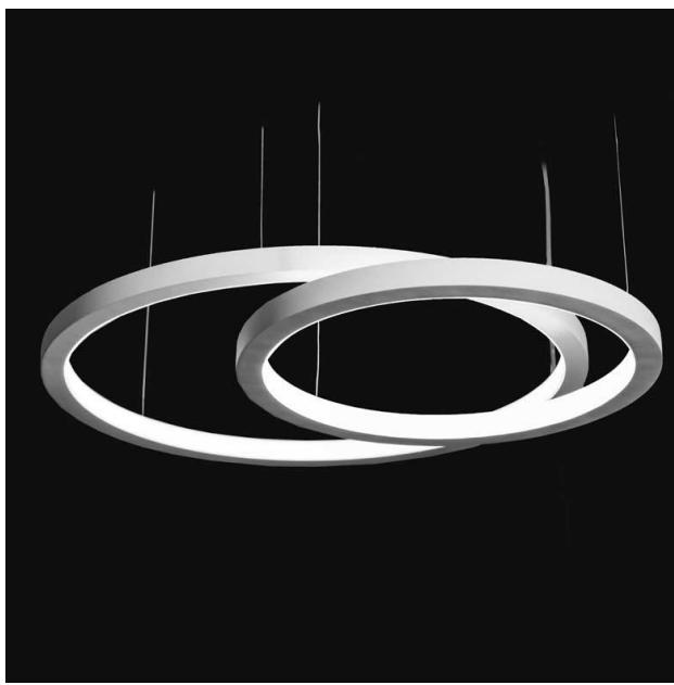
Luminária circular pendente iluminação direta e indireta, 40W 3000K IRC90. Corpo em alumínio. Acabamento branco, preto ou especial. Controle óptico principal através de facho difuso. Luminária grau de proteção IP-20. Driver corrente constante Liga/Desliga, Triac, 1-10V ou Dali (consultar condições). Tensão de trabalho 220V ou Bivolt.
