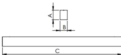
Luminária linear pendente iluminação direta, 15Wm 2700K IRC>80. Corpo em alumínio. Acabamento Branca, Preta ou Especial. Controle óptico principal através de difusor em poliestireno translúcido. Luminária grau de proteção IP-20. Driver corrente constante Liga/Desliga, Triac, 1-10V ou Dali (consultar condições). Tensão de trabalho 220V ou Bivolt.
