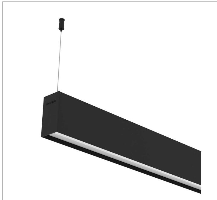
Luminária linear pendente iluminação direta, 15Wm 4000K IRC>80. Corpo em alumínio. Acabamento Branca, Preta ou Especial. Controle óptico principal através de difusor em poliestireno translúcido. Luminária grau de proteção IP-20. Driver corrente constante Liga/Desliga, Triac, 1-10V ou Dali (consultar condições). Tensão de trabalho 220V ou Bivolt.
