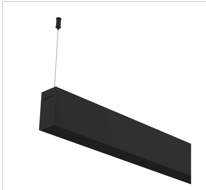
Luminária linear pendente iluminação indireta, 15Wm 2700K IRC>80. Corpo em alumínio. Acabamento Branca, Preta ou Especial. Controle óptico principal através de difusor em poliestireno translúcido. Luminária grau de proteção IP-20. Driver corrente constante Liga/Desliga, Triac, 1-10V ou Dali (consultar condições). Tensão de trabalho 220V ou Bivolt.
