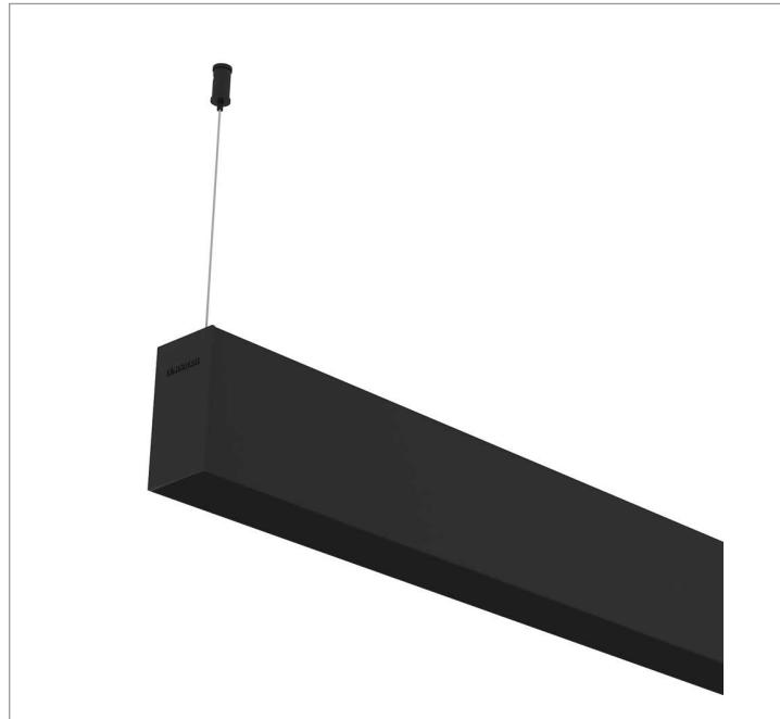
Luminária linear pendente iluminação indireta, 15Wm 4000K IRC>80. Corpo em alumínio. Acabamento Branca, Preta ou Especial. Controle óptico principal através de difusor em poliestireno translúcido. Luminária grau de proteção IP-20. Driver corrente constante Liga/Desliga, Triac, 1-10V ou Dali (consultar condições). Tensão de trabalho 220V ou Bivolt.
