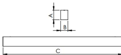
Luminária linear pendente iluminação direta e indireta, 2X25Wm 4000K IRC>80. Corpo em alumínio. Acabamento Branca, Preta ou Especial. Controle óptico principal através de difusor em poliestireno translúcido. Luminária grau de proteção IP-20. Driver corrente constante Liga/Desliga, Triac, 1-10V ou Dali (consultar condições). Tensão de trabalho 220V ou Bivolt.
