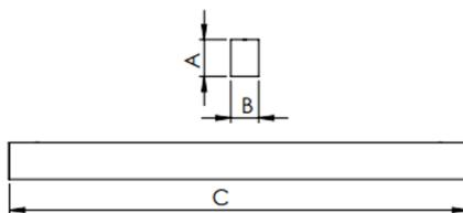
Luminária linear de sobrepor, 15Wm 3000K IRC>80. Corpo em alumínio. Acabamento Branca, Preta ou Especial. Controle óptico principal através de difusor em poliestireno translúcido. Luminária grau de proteção IP-20. Driver corrente constante Liga/Desliga, Triac, 1-10V ou Dali (consultar condições). Tensão de trabalho 220V ou Bivolt.
