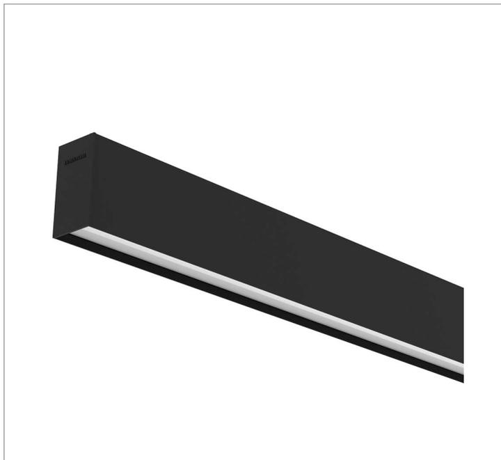
Luminária linear de sobrepor, 25Wm 5000K IRC>80. Corpo em alumínio. Acabamento Branca, Preta ou Especial. Controle óptico principal através de difusor em poliestireno translúcido. Luminária grau de proteção IP-20. Driver corrente constante Liga/Desliga, Triac, 1-10V ou Dali (consultar condições). Tensão de trabalho 220V ou Bivolt.
