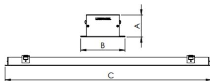
Luminária linear de embutir em forro de gesso, 25Wm 5000K IRC>80. Corpo em alumínio. Acabamento Branca, Preta ou Especial. Controle óptico principal através de difusor em acrílico translúcido. Luminária grau de proteção IP-20. Driver corrente constante Liga/Desliga, Triac, 1-10V ou Dali (consultar condições). Tensão de trabalho 220V ou Bivolt.
