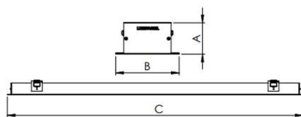
Luminária linear de embutir em forro de gesso, 37Wm 3000K IRC>80. Corpo em alumínio. Acabamento Branca, Preta ou Especial. Controle óptico principal através de difusor em acrílico translúcido. Luminária grau de proteção IP-20. Driver corrente constante Liga/Desliga, Triac, 1-10V ou Dali (consultar condições). Tensão de trabalho 220V ou Bivolt.
