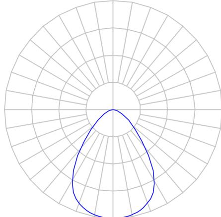
Luminária circular para perfilado, 100W 5000K IRC>80. Corpo em alumínio. Acabamento preto. Controle óptico principal através de lente facho 60°. Luminária grau de proteção IP-44. Driver corrente constante Liga/Desliga, 1-10V ou Dali (consultar condições). Tensão de trabalho 220V.
