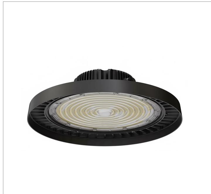
Luminária circular para perfilado, 100W 5000K IRC>80. Corpo em alumínio. Acabamento preto. Controle óptico principal através de lente facho 60°. Luminária grau de proteção IP-44. Driver corrente constante Liga/Desliga, 1-10V ou Dali (consultar condições). Tensão de trabalho 220V.
