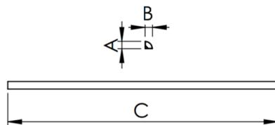
Luminária linear, 15Wm 3000K IRC>80. Corpo em alumínio. Acabamento Branca, Preta ou Especial. Controle óptico principal através de facho difuso. Luminária grau de proteção IP-20. Driver corrente constante Liga/Desliga, Triac, 1-10V ou Dali (consultar condições). Tensão de trabalho 220V ou Bivolt.
