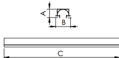
Luminária linear de embutir no-frame em forro de gesso, 25Wm 2700K IRC90. Corpo em alumínio. Acabamento branco, preto ou especial. Controle óptico principal através de iluminação indireta rebatida Luminária grau de proteção IP-20. Driver corrente constante Liga/Desliga, Triac, 1-10V ou Dali (consultar condições). Tensão de trabalho 220V ou Bivolt.
