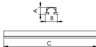
Luminária linear de embutir no-frame em forro de gesso, 25Wm 3000K IRC90. Corpo em alumínio. Acabamento branco, preto ou especial. Controle óptico principal através de iluminação indireta rebatida Luminária grau de proteção IP-20. Driver corrente constante Liga/Desliga, Triac, 1-10V ou Dali (consultar condições). Tensão de trabalho 220V ou Bivolt.
