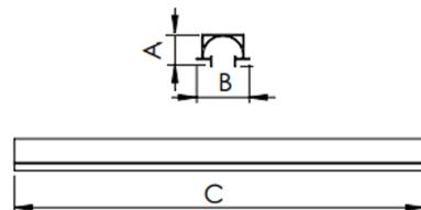
Luminária linear de embutir no-frame em forro de gesso, 25Wm 4000K IRC90. Corpo em alumínio. Acabamento branco, preto ou especial. Controle óptico principal através de iluminação indireta rebatida Luminária grau de proteção IP-20. Driver corrente constante Liga/Desliga, Triac, 1-10V ou Dali (consultar condições). Tensão de trabalho 220V ou Bivolt.
