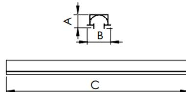
Luminária linear de embutir no-frame em forro de gesso, 50Wm 3000K IRC90. Corpo em alumínio. Acabamento branco, preto ou especial. Controle óptico principal através de iluminação indireta rebatida Luminária grau de proteção IP-20. Driver corrente constante Liga/Desliga, Triac, 1-10V ou Dali (consultar condições). Tensão de trabalho 220V ou Bivolt.
