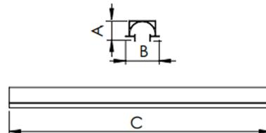
Luminária linear de embutir no-frame em forro de gesso, 50Wm 5000K IRC90. Corpo em alumínio. Acabamento branco, preto ou especial. Controle óptico principal através de iluminação indireta rebatida Luminária grau de proteção IP-20. Driver corrente constante Liga/Desliga, Triac, 1-10V ou Dali (consultar condições). Tensão de trabalho 220V ou Bivolt.
