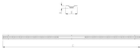
Perfil com iluminação back light própria para iluminação uniforme de lona tensionada, 4000K IRC80. Driver corrente constante Liga/Desliga, Triac, 1-10V ou Dali (consultar condições). Tensão de trabalho 220V ou Bi-volt.
