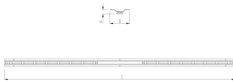
Perfil com iluminação back light própria para iluminação uniforme de lona tensionada, 3000K IRC80. Driver corrente constante Liga/Desliga, Triac, 1-10V ou Dali (consultar condições). Tensão de trabalho 220V ou Bi-volt.
