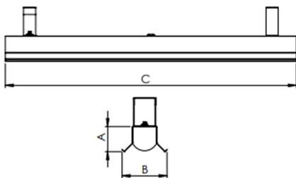
Luminária retangular para perfilado, 20W 3000K IRC>80. Corpo em alumínio. Acabamento Branca. Controle óptico principal através de facho difuso. Luminária grau de proteção IP-20. Driver corrente constante Liga/Desliga, Triac, 1-10V ou Dali (consultar condições). Tensão de trabalho 220V ou Bivolt.
