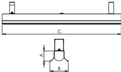
Luminária retangular para perfilado, 20W 5000K IRC>80. Corpo em alumínio. Acabamento Branca. Controle óptico principal através de facho difuso. Luminária grau de proteção IP-20. Driver corrente constante Liga/Desliga, Triac, 1-10V ou Dali (consultar condições). Tensão de trabalho 220V ou Bivolt.
