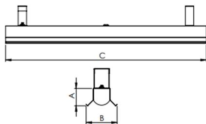
Luminária retangular para perfilado, 40W 4000K IRC>80. Corpo em alumínio. Acabamento Branca. Controle óptico principal através de facho difuso. Luminária grau de proteção IP-20. Driver corrente constante Liga/Desliga, Triac, 1-10V ou Dali (consultar condições). Tensão de trabalho 220V ou Bivolt.
