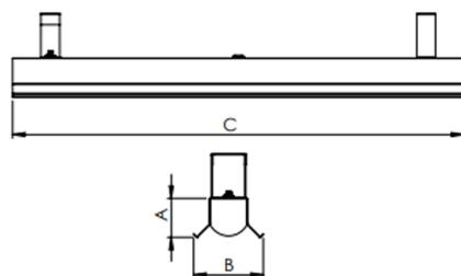
Luminária retangular para perfilado, 56W 3000K IRC>80. Corpo em alumínio. Acabamento Branca. Controle óptico principal através de facho difuso. Luminária grau de proteção IP-20. Driver corrente constante Liga/Desliga, Triac, 1-10V ou Dali (consultar condições). Tensão de trabalho 220V ou Bivolt.
