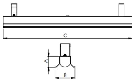
Luminária retangular para perfilado, 56W 4000K IRC>80. Corpo em alumínio. Acabamento Branca. Controle óptico principal através de facho difuso. Luminária grau de proteção IP-20. Driver corrente constante Liga/Desliga, Triac, 1-10V ou Dali (consultar condições). Tensão de trabalho 220V ou Bivolt.
