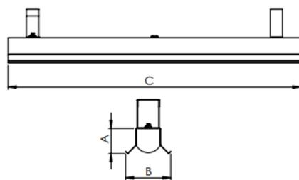
Luminária retangular para perfilado, 56W 5000K IRC>80. Corpo em alumínio. Acabamento Branca. Controle óptico principal através de facho difuso. Luminária grau de proteção IP-20. Driver corrente constante Liga/Desliga, Triac, 1-10V ou Dali (consultar condições). Tensão de trabalho 220V ou Bivolt.
