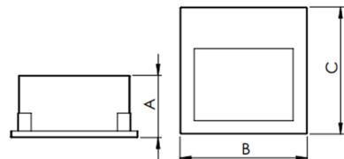
Luminária quadrada, 4W 3000K IRC>80. Corpo em alumínio. Acabamento Branca, Preta ou Especial. Controle óptico principal através de refletor facho assimétrico. Luminária grau de proteção IP-20. Driver corrente constante Liga/Desliga Tensão de trabalho 127V ou 220V.
