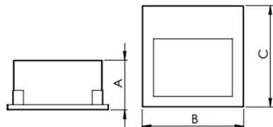
Luminária quadrada, 4W 5000K IRC>80. Corpo em alumínio. Acabamento Branca, Preta ou Especial. Controle óptico principal através de refletor facho assimétrico. Luminária grau de proteção IP-20. Driver corrente constante Liga/Desliga Tensão de trabalho 127V ou 220V.
