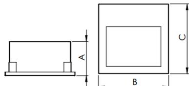
Luminária retangular, 8W 3000K IRC>80. Corpo em alumínio. Acabamento Branca, Preta ou Especial. Controle óptico principal através de refletor facho assimétrico. Luminária grau de proteção IP-20. Driver corrente constante Liga/Desliga Tensão de trabalho 127V ou 220V.
