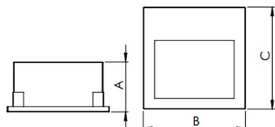
Luminária retangular, 8W 5000K IRC>80. Corpo em alumínio. Acabamento Branca, Preta ou Especial. Controle óptico principal através de refletor fachó assimétrico. Luminária grau de proteção IP-20. Driver corrente constante Liga/Desliga Tensão de trabalho 127V ou 220V.
