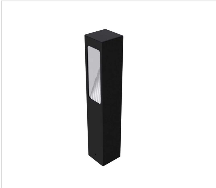
Pétala quadrada, 4W 3000K IRC>80. Corpo em alumínio. Acabamento Branca, Preta ou Especial. Controle óptico principal através de refletor fecho assimétrico. Luminária grau de proteção IP-65. Driver corrente constante Liga/Desliga Tensão de trabalho 127V ou 220V.
