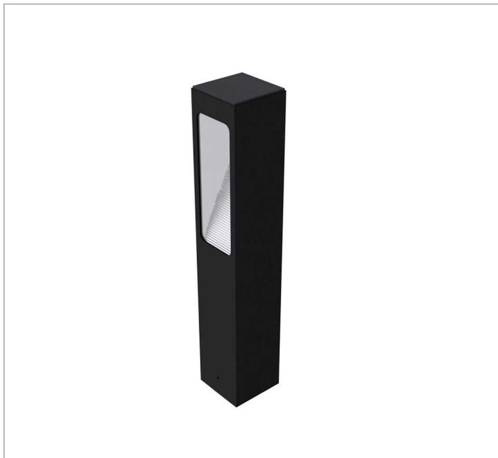
Pétala quadrada, 4W 4000K IRC>80. Corpo em alumínio. Acabamento Branca, Preta ou Especial. Controle óptico principal através de refletor facho assimétrico. Luminária grau de proteção IP-65. Driver corrente constante Liga/Desliga Tensão de trabalho 127V ou 220V.
